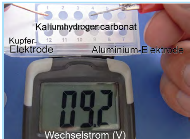
Abb. 4. Aluminium- und Kupfer-Elektroden bei einer Wechselspannung
