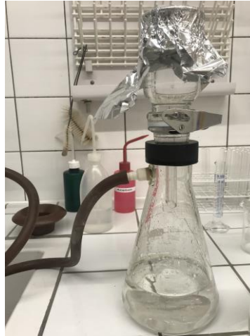
Abb. 3: Filtrationseinrichtung (eigene Aufnahme)
