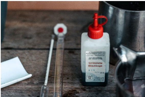
Abbildung 7: Prozess der Titration mit Titrovin-Blaulauge, gemäss Titration befinden sich zirka 9g/L Säure im Traubensaft
