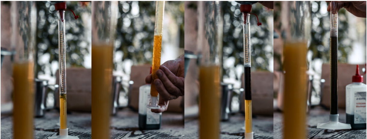
Abbildung 7: Prozess der Titration mit Titrovin-Blaulauge, gemäss Titration befinden sich zirka 9g/L Säure im Traubensaft
