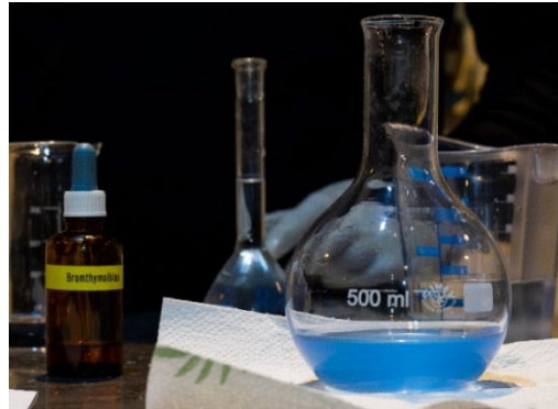
Abbildung 11: Natronlauge, 10%-ige Pellets-Lösung in 100 ml, Indikator Bromthymolblau, Reinheit > 99.3%
