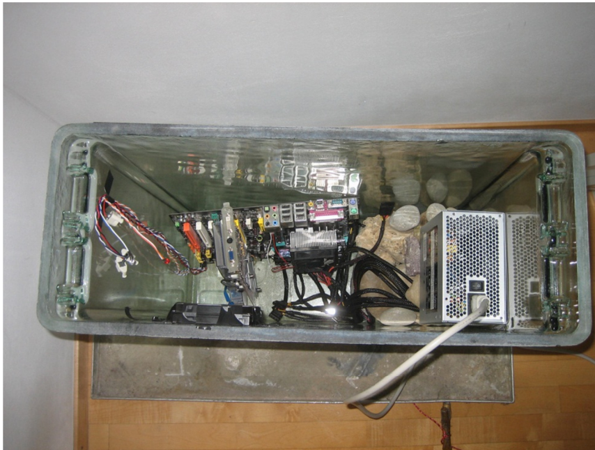
Abb. 6 Aquarium mit eingebauten PC ohne Öl
