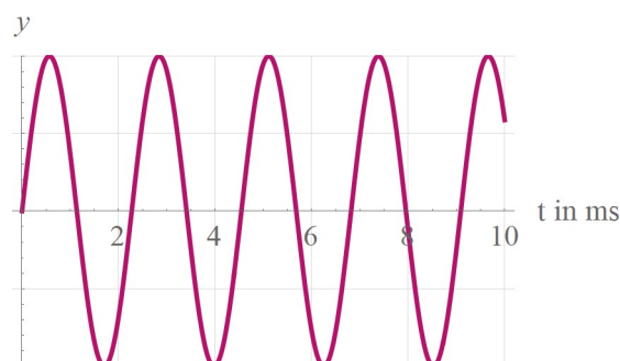
Abbildung 26: Der Graph einer Sinusschwingung mit einer Frequenz von 440 Hz. Eine Stimmgabel besitzt beispielsweise eine ähnliche Schwingungskurve.
