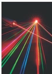
Monochromatische Strahlung. Laser erzeugen monochromatisches Licht, also Licht einer einzigen Wellenlänge. Verschiedene Laser erzeugen Licht verschiedener Wellenlängen. In der Abbildung sind die Strahlen einiger Laser dargestellt, die sichtbares Licht unterschiedlicher Farben erzeugen. Andere Laser erzeugen nicht sichtbares Licht (z. B. infrarotes oder ultraviolettes Licht).
