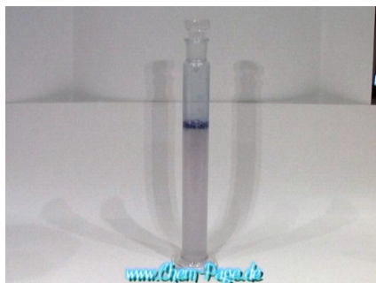
Eine Mischung aus Natronlauge, Glucose und Methyleneblau.
