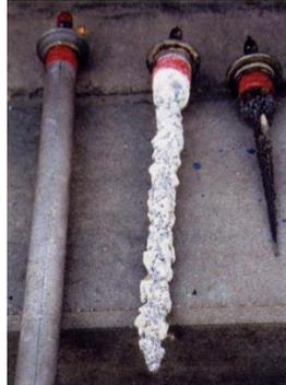
Abb.7: Opferanoden aus Warmwasserbereitern
